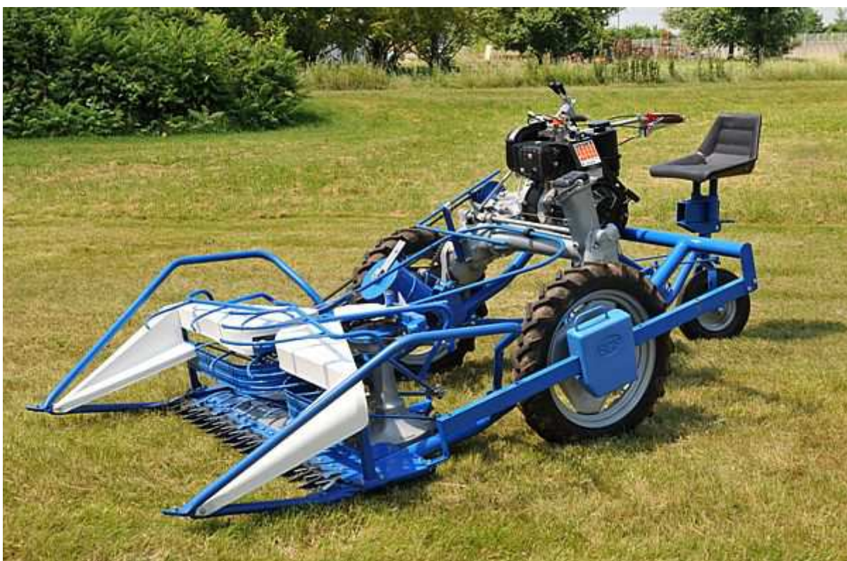
Rys 4. BCS 622 z zamontowaną wiązałką SPECJAL oraz dołączonym wózkiem operatora.
