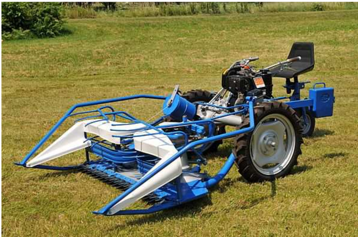
Rys 3. BCS 622 z zamontowaną wiązałką STANDARD oraz dołączonym wózkiem operatora.
