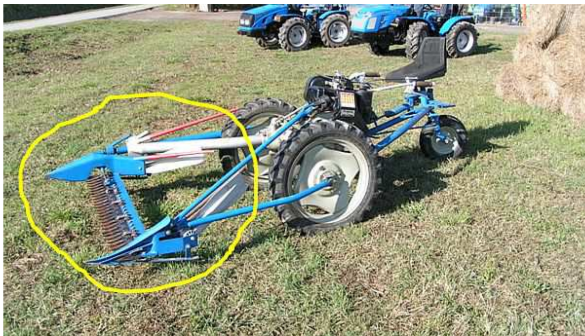
Rys 2. Listwa kosząca wiązalki BCS 622
